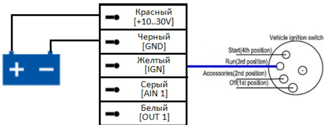
Кроме того, можно контролировать сигнал «Зажигание», найдя любой источник положительного сигнала, который работает только при включенном зажигании, например, источник питания автомагнитолы.
