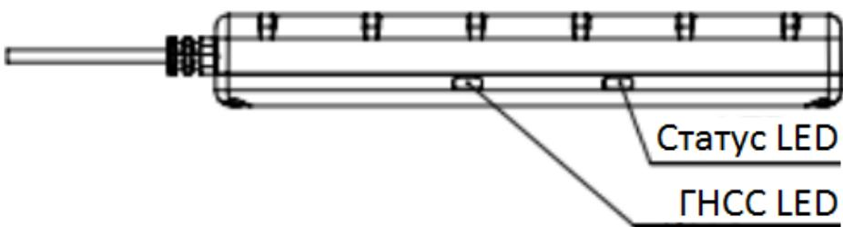
Статус приема сигналов определяется по характеру их свечения:
